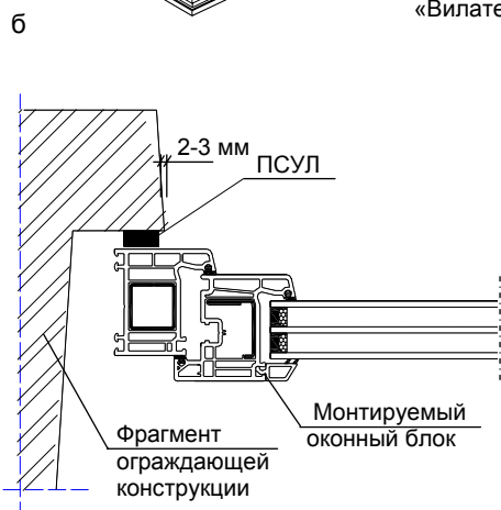
Рис.6.2. Примеры подготовки отдельных конструктивных элементов оконного блока к монтажу: а – крепление подставочного профиля; б – наклейка саморасширяющейся уплотнительной ленты
