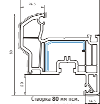
Створка 80 мм псм, арт. № 103.238 усилитель арт. № 113.292 усилитель цветной створки арт. № 113.294 усилитель сдвижной двери арт. № 113.295
