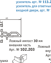
Ложный импост 30 мм внешняя часть Арт. № 102.203 Заглушка для 102.203 арт. № 109.433
