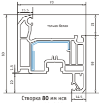
Створка 80 мм нсв Арт. № 103.200 усилитель арт. № 113.292
