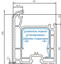
Створка 105 мм нсв Арт. № 103.202 усилитель арт. № 113.270
